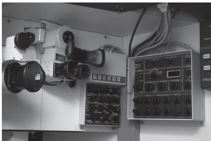
Kampvognssimulatorens er et eksempel på en delmålssimulator. Her ses skyttens arbejdsplads. (P. Sjøstedt)
