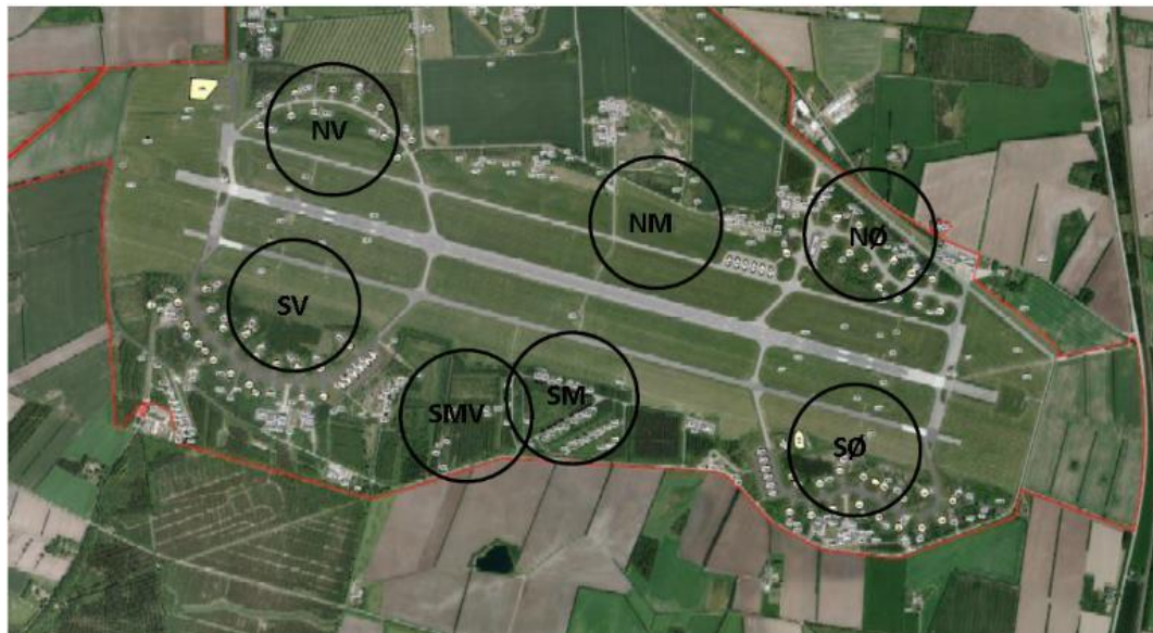
Figur 3-7 Alternative placeringer, undersøgt ved estimering af terminalstøj.
