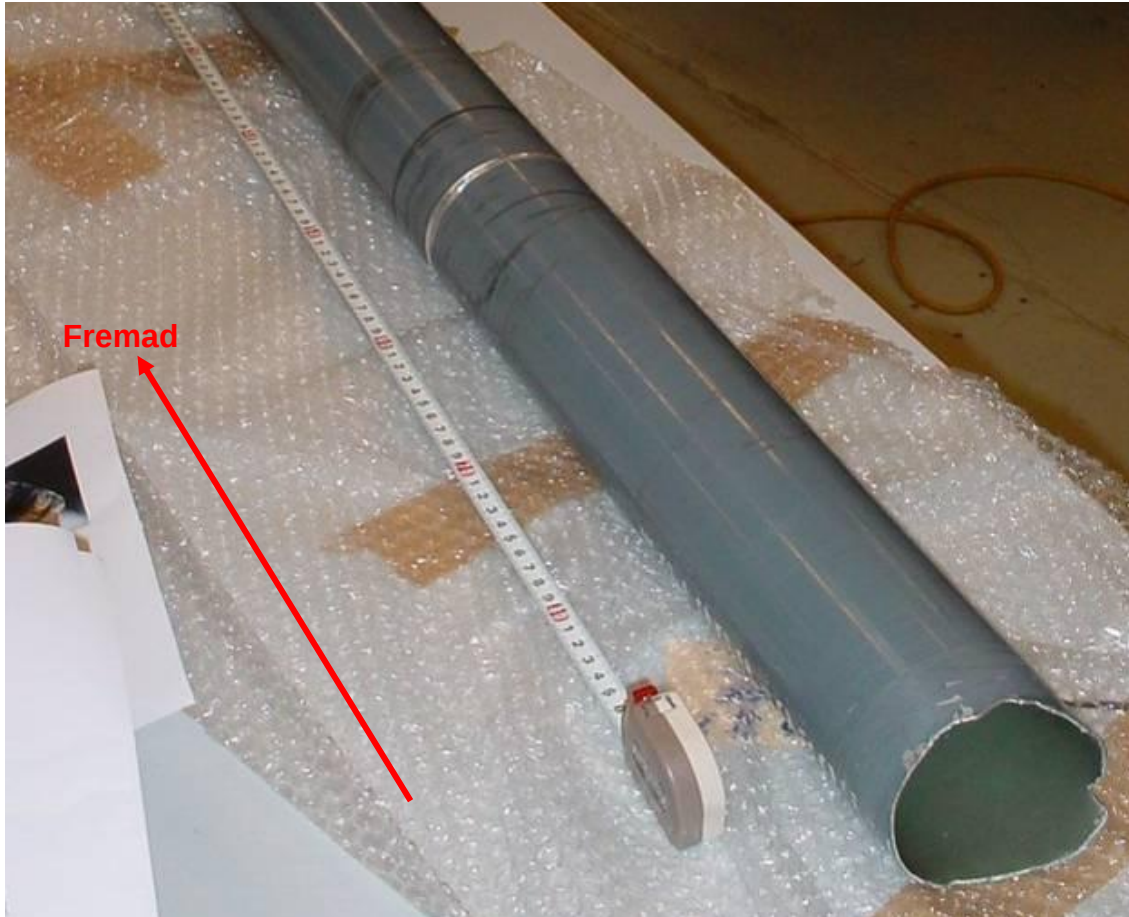
Figur 12 Vinkelret overbelastningsbrud vist på den forreste del af TAE1869
