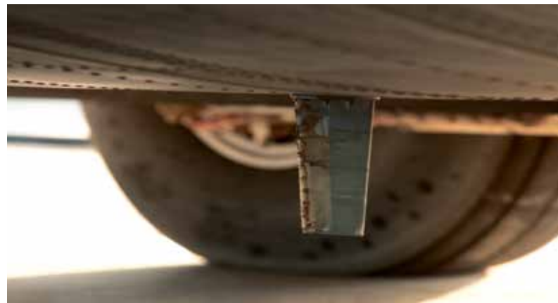
Billederne viser undersiden af flyet. Der sidder flere antenner, som bliver ramt af sten, sand og støv, når der bliver landet på grus. Antennerne bliver repareret så godt som muligt, men de skal næsten alle skiftes med jævne mellemrum.
