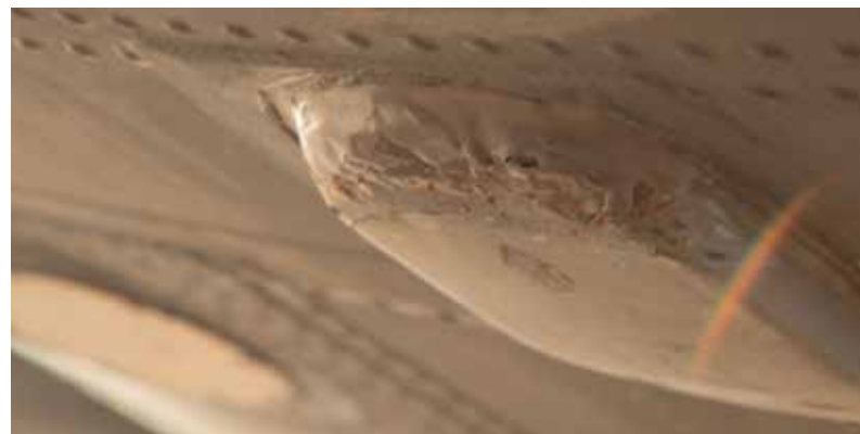
Billederne viser undersiden af flyet. Der sidder flere antenner, som bliver ramt af sten, sand og støv, når der bliver landet på grus. Antennerne bliver repareret så godt som muligt, men de skal næsten alle skiftes med jævne mellemrum.
