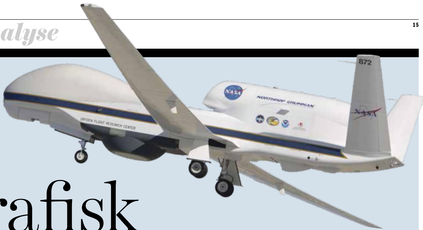
NASA har to Global Hawk UAV til videnskabelig brug – de kan flyve i 31 timer, tilbagelægge 10.000 nautiske mil og operere i 65.000 fods højde. Med danske sensorer skal Global Hawk og NASA kortlægge jordskorpen under Grønlands indlandsis. Foto: NASA
