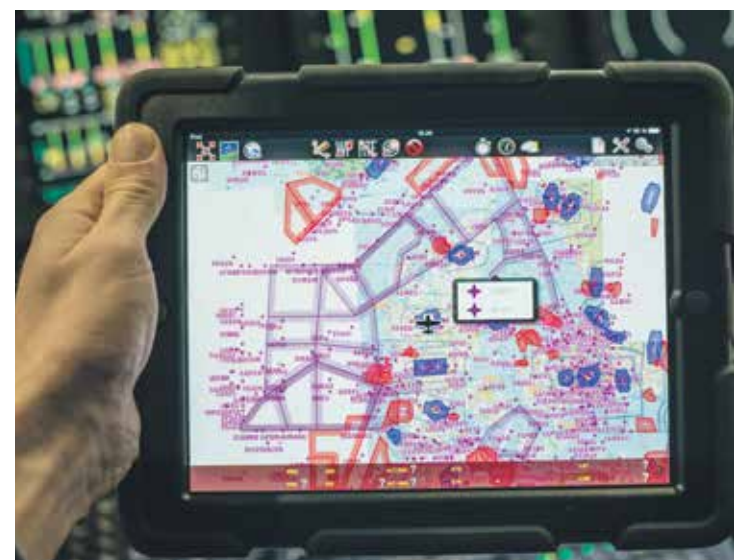
Det er hurtigere at bruge en iPad end papirkort og bøger, når piloterne skal bruge informationer om lufthavne, radiofrekvenser, lukkede luftrum og meget andet under en flyvning.
