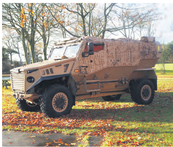
Eagle V: (tv) Terrænegenskaber er testet med maksimal belastning. Anordningen på taget vejer det samme som en stabiliseret våbenstation for tungt maskingevær.
