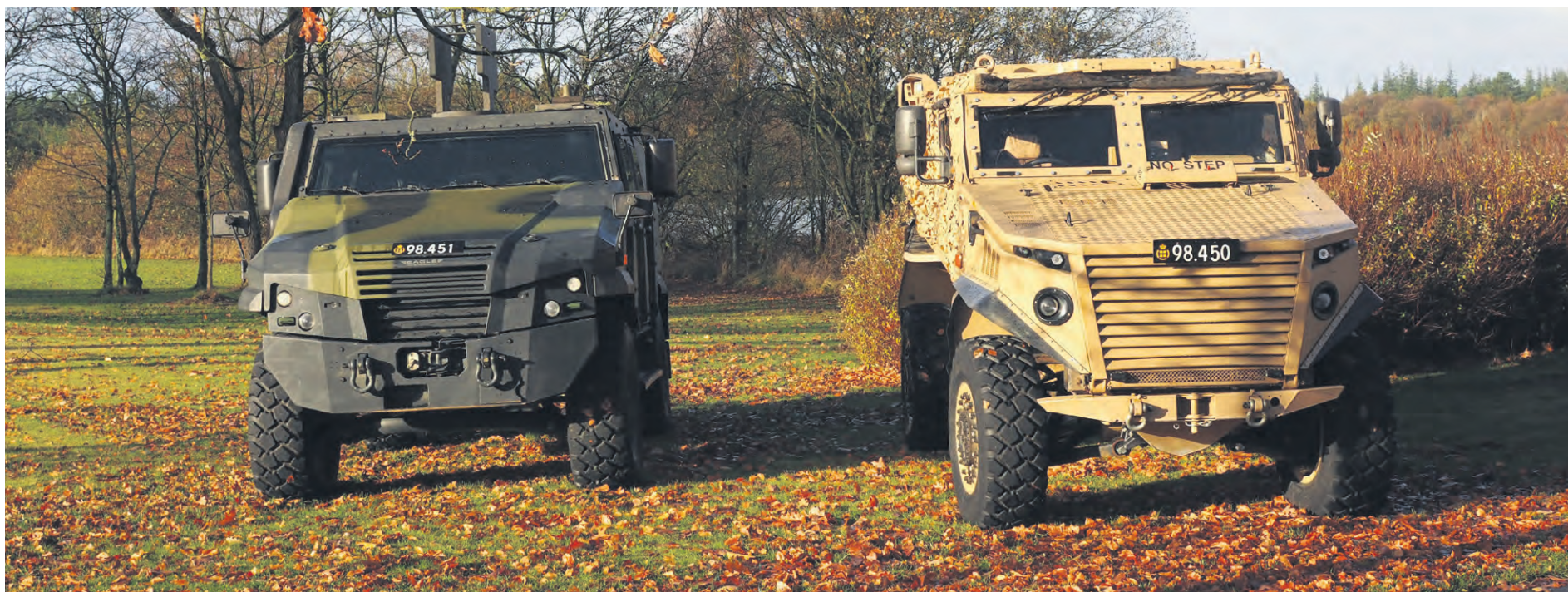
Eagle V: (tv) Terrænegenskaber er testet med maksimal belastning. Anordningen på taget vejer det samme som en stabiliseret våbenstation for tungt maskingevær.
