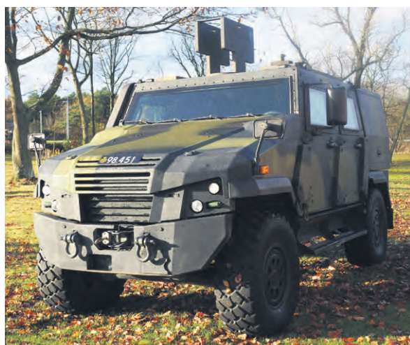
Eagle V: (tv) Terrænegenskaber er testet med maksimal belastning. Anordningen på taget vejer det samme som en stabiliseret våbenstation for tungt maskingevær.
