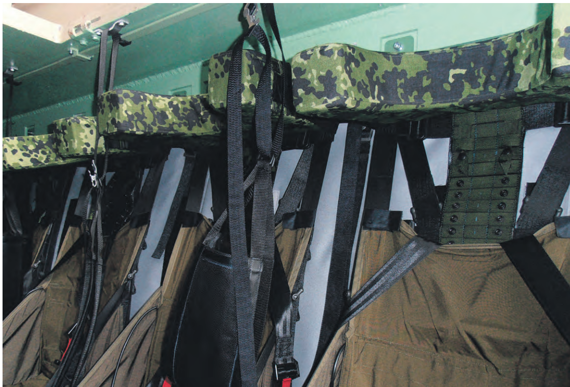
De fleste af soldaterne i en pansret mandskabsvogn sidder sidelæns under kørsel. Karen har udviklet en pude, der holder deres hoved korrekt, så de er bedre sikret mod skader, hvis der sker en eksplosion.
