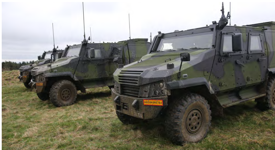
De nye pansrede patruljevogne, Eagle 5, er en opgraderet version af Hærens nuværende Eagle IV, med en bedre beskyttelse og større nyttelast. De nye Eagle 5 skal på sigt erstatte Eagle IV-flåden, og derfor er Forsvarsministeriets Materiel- og Indkøbsstyrelse allerede i gang med at anskaffe flere af disse køretøjer.
