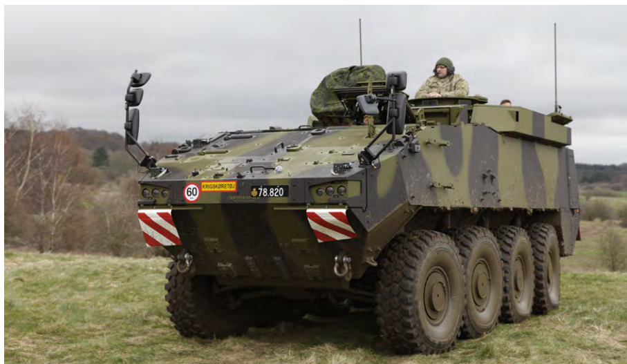
Piranha 5 er et moderne køretøj, som vil sikre soldaterne en større sikkerhed og mobilitet. De nye pansrede mandskabsvogne erstatter de 55 år gamle M113 pansrede mandskabsvogne. Piranha 5 opbygges og produceres i seks grundlæggende varianter; infanteri-, ingeniør-, kommandostations-, mekaniker-, ambulance- og mortérvarianten.
